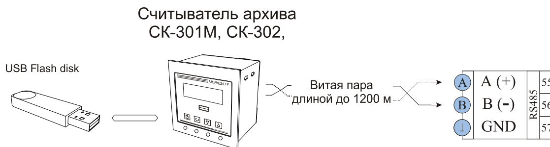
Рис 5.4 Типовая схема подключения прибора к считывателям архива.
